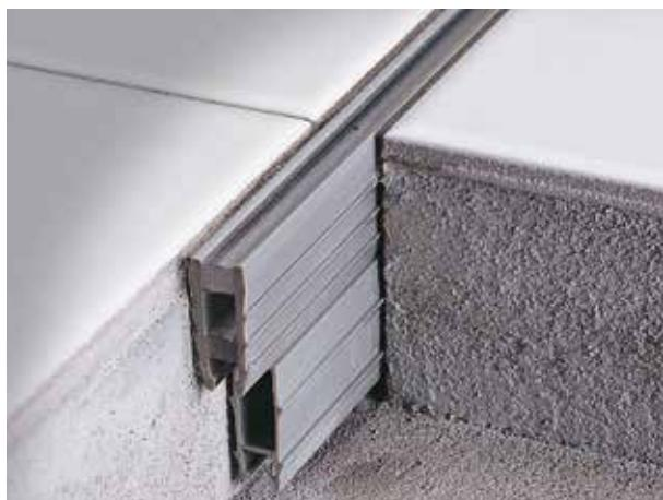
Junta de fraccionamiento modular en material sintético para la colocación. Diseñadas para dividir grandes áreas de baldosas en áreas más pequeñas. El uso de las correspondientes prolongaciones entrelazadas (una o más) permite alcanzar alturas importantes, ofrecen una protección limitada al borde del pavimento. Compensan pequeños movimientos debidos a la dilatación de los materiales de soporte, pero exclusivamente en compresión o deslizamiento.
